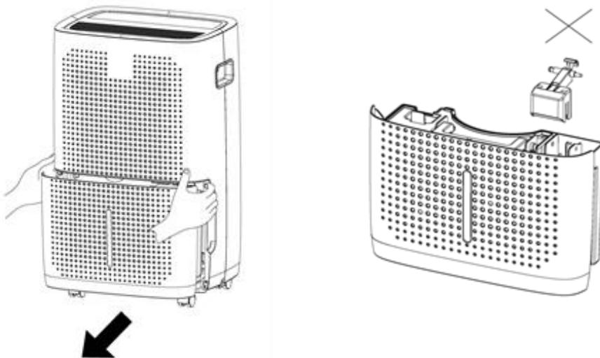
II. Vacíe el tanque y luego vuelva a colocarlo en su posición adecuada. Asegúrese de que esté insertado correctamente.
