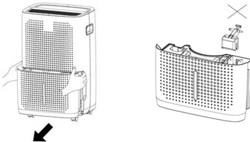
II. Opróżnij zbiornik, a następnie umieść go z powrotem w odpowiednim miejscu. Upewnij się, że jest on prawidłowo wsunięty.
