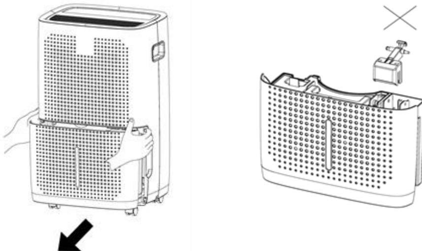
II. Goliți rezervorul, apoi puneti-l înapoi în poziția corectă. Asigurați-vă că este introdus corect.
